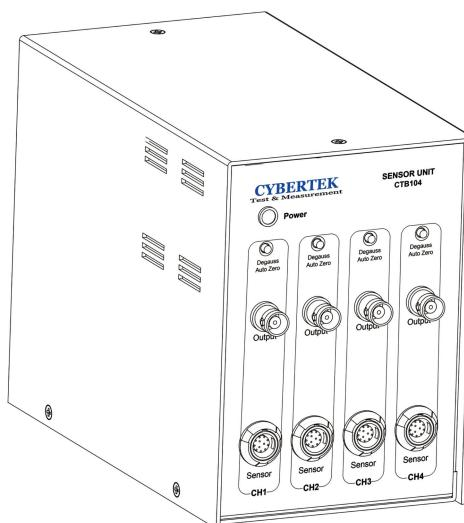
**CTB104 传感器单元：**探头的传感器单元，4 通道，可以同时接 4 个电流探头，包含探头连接接口，BNC 输出接口，消磁调零按键，和电源指示灯功能。
