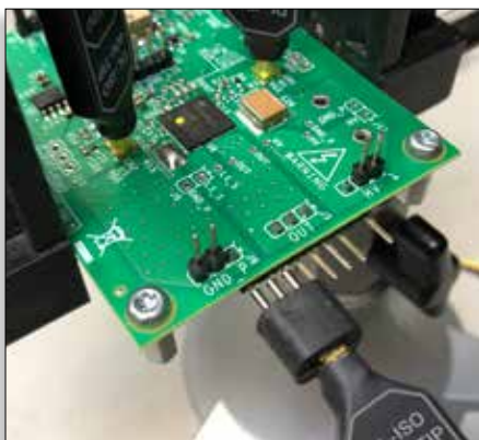
DL-ISO 测量 V_{gs} (MMCX) 和 V_{ds} (插头引脚) 信号
