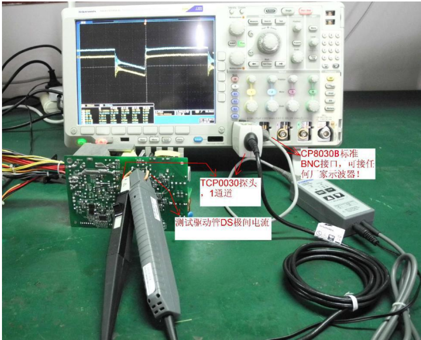
图 11 1 通道为 TEK TCP0030 电流探头 2 通道为本公司的 CP8030B
