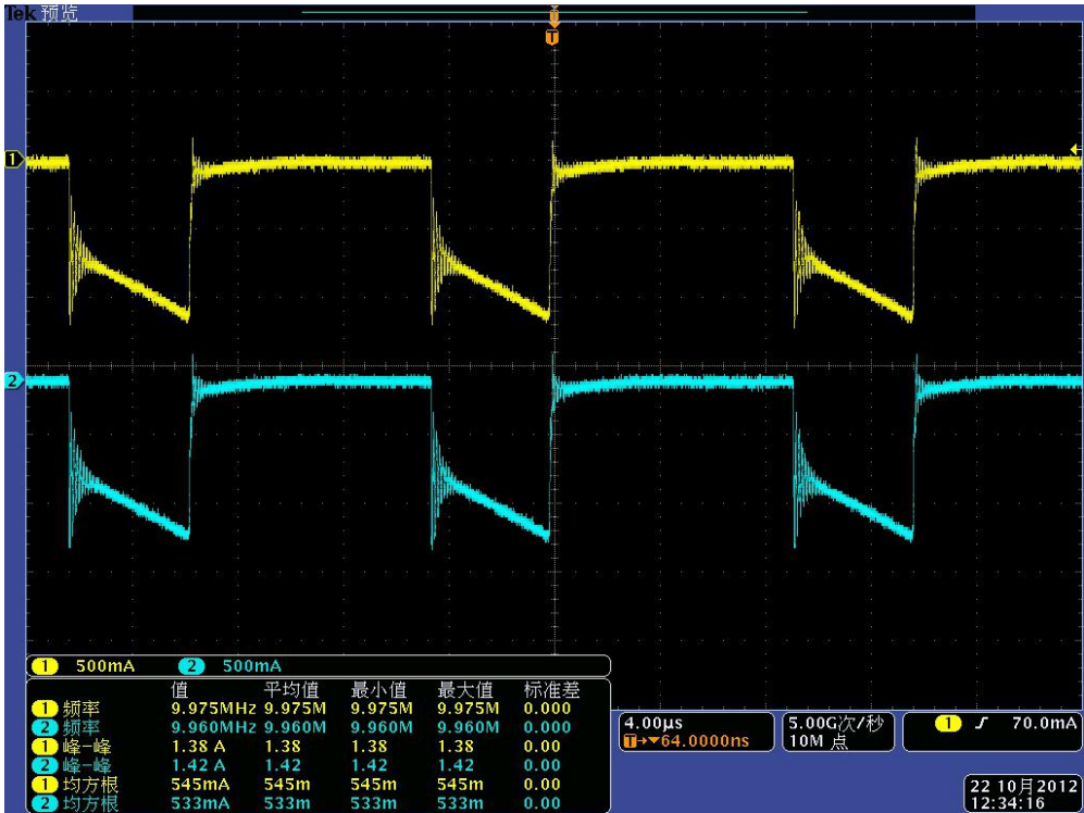
图 12 黄线为泰克 TCP312 蓝线为 CP8030B 实测数据对比
